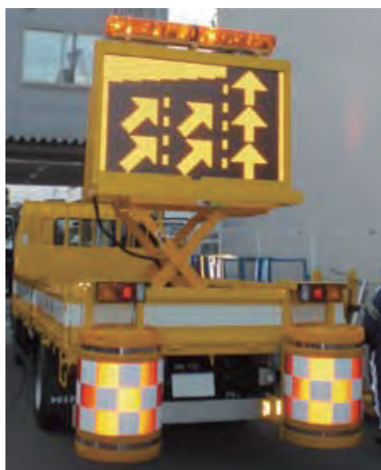
テーブルリフト昇降 (上昇時)
