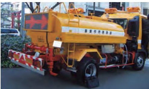
散水車 車載標識
